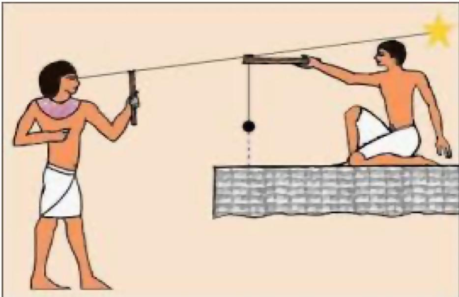
*Figura 6) Allineamento verticale e inclinato nel sistema costruttivo egizio*
