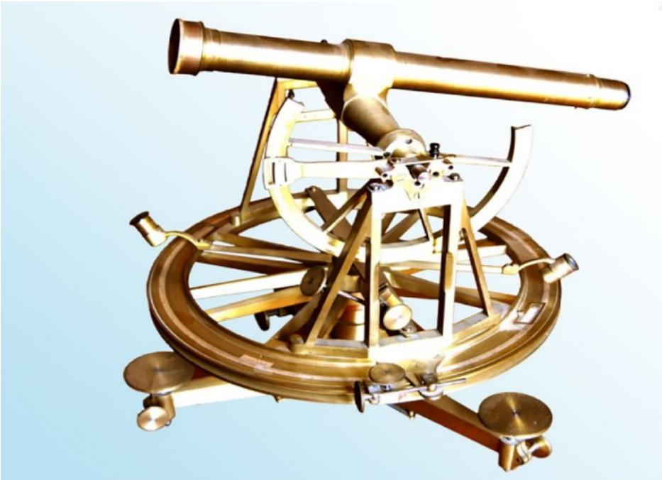
Teodolite ripetitore di Reichenbach costruito prima del 1817 utilizzato per misure della terra, si osserva che l'evoluzione del cannocchiale è l'utilizzo di cerchi per la lettura degli angoli orizzontali e verticali
