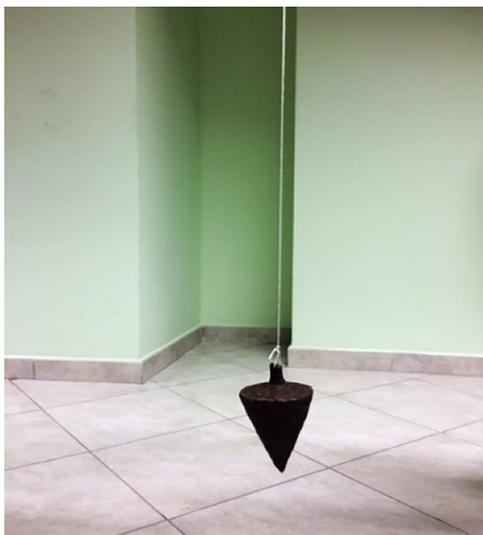
*Metodo utilizzato per costruire in perfetta verticalità ma anche per assegnare dei piani inclinati. Nella figura si vede il filo perfettamente parallelo allo spigolo del muro.*
