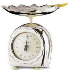
la **bilancia** è lo strumento usato per misurare le masse. In figura è mostrato un modello analogico con le seguenti caratteristiche: la portata è di 3 kg, la sensibilità è di 1 su 20 g, cioè una tacca vale 20 g.
