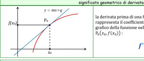
la derivata prima di una funzione f(x) in un punto  $x_0$  rappresenta il coefficiente angolare della retta tangente al grafico della funzione nel punto di ascissa  $x_0$  cioè nel punto  $P_0(x_0, f(x_0))$ :
